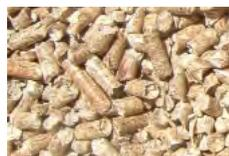
**Le granulé de bois** est obtenu par compression d'éléments fins de bois séchés. Il est particulièrement adapté aux chaudières et aux poêles des particuliers.
